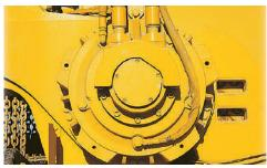
ROTARY POWER TRENCHER DRIVE MOTOR.
