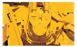
ROTARY POWER TRENCHER DRIVE MOTOR.
